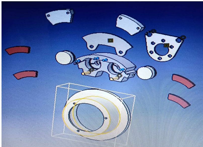
Figura 21. Componentes da Pinça de freio em CAD
