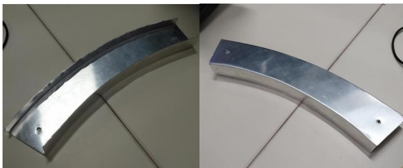
Figura 22. Primeira Caverna Produzida Com Dupla Curvatura
