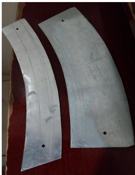
Figura 18. Gabaritos (Chapelonas) de corte do blank
