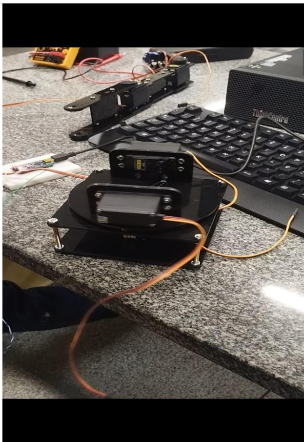
FIGURA 1: Início da montagem da base do braço robótico.
