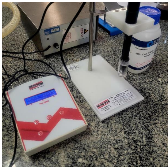
Figura 3. Calibração do pHmetro de bancada.
