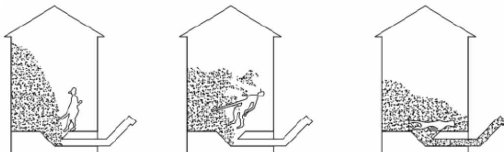
Figura 16: SOTERRAMENTO POR UMA PAREDE DE GRÃOS
