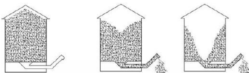
Figura 14: PROCESSO DE DESCARREGAMENTO DE UM SILO POR GRAVIDADE
