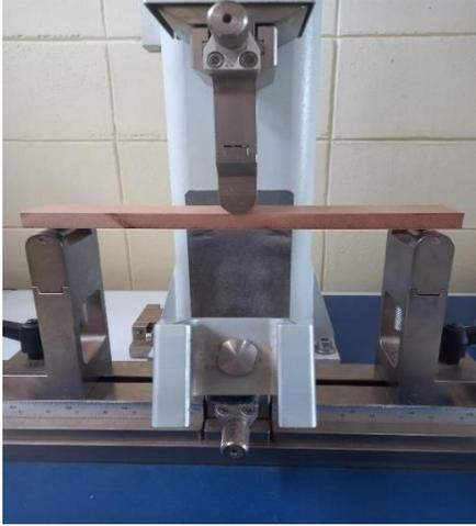
*Figura 7 – Amostra após o teste de limite de fendimento.*
