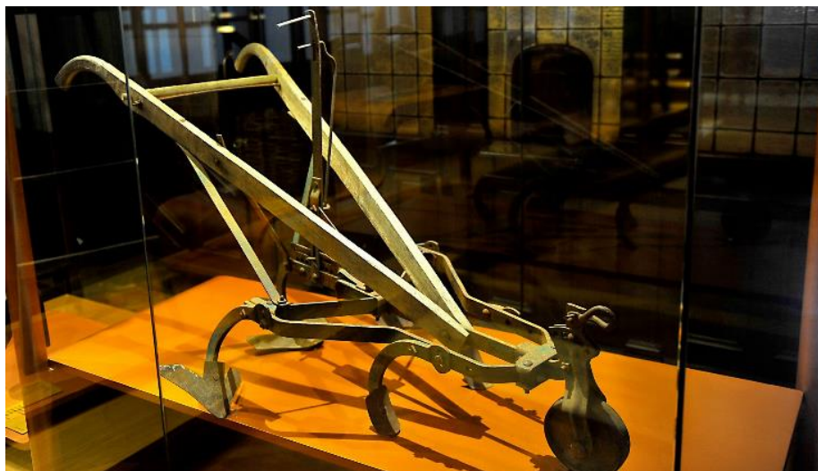
Figura2. Ferramenta agrícola à tração animal, usada no preparo da terra a ser plantada, escavando, cortando e revolvendo o solo para afrouxá-lo. Década de 1950, Madeira e Metal.
