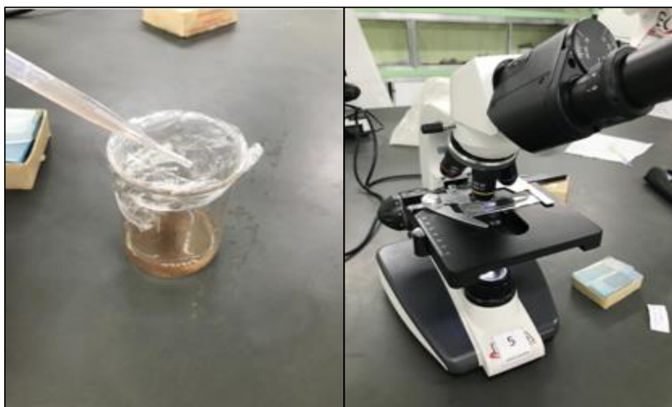
Figura 17. Processo de aplicação da solução de terra no microscópio para contagem microbiológica
