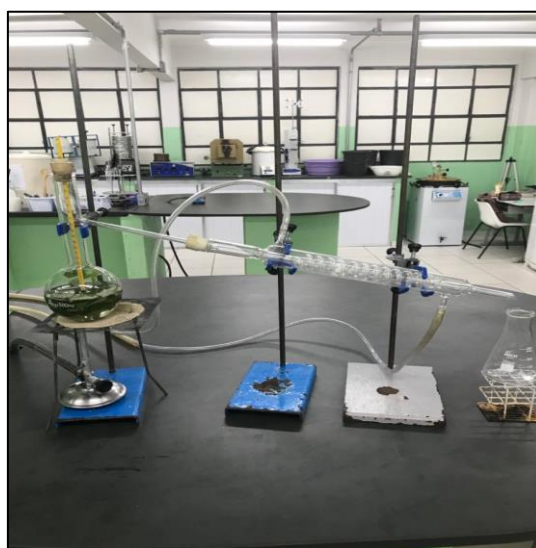
Figura 12. Representação do sistema de Hidrodestilação
