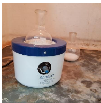
Figura 9. Aquecimento em manta térmica.
