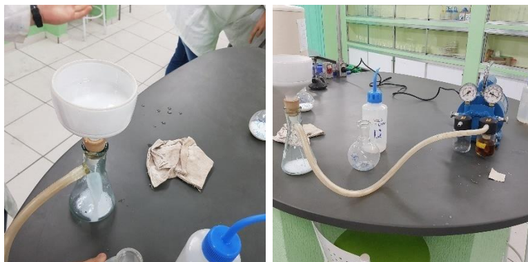
Figura 10 - Filtração a vácuo.
