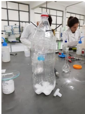
Figura 12a – Montagem da Armadilha
