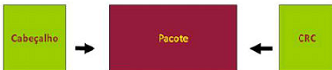
Figura 15: Estrutura da camada de enlace.
