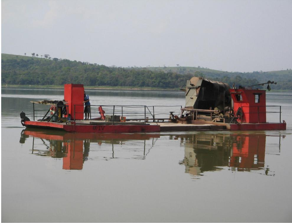
Figura 8 – Embarcação de extração de areia fina.
