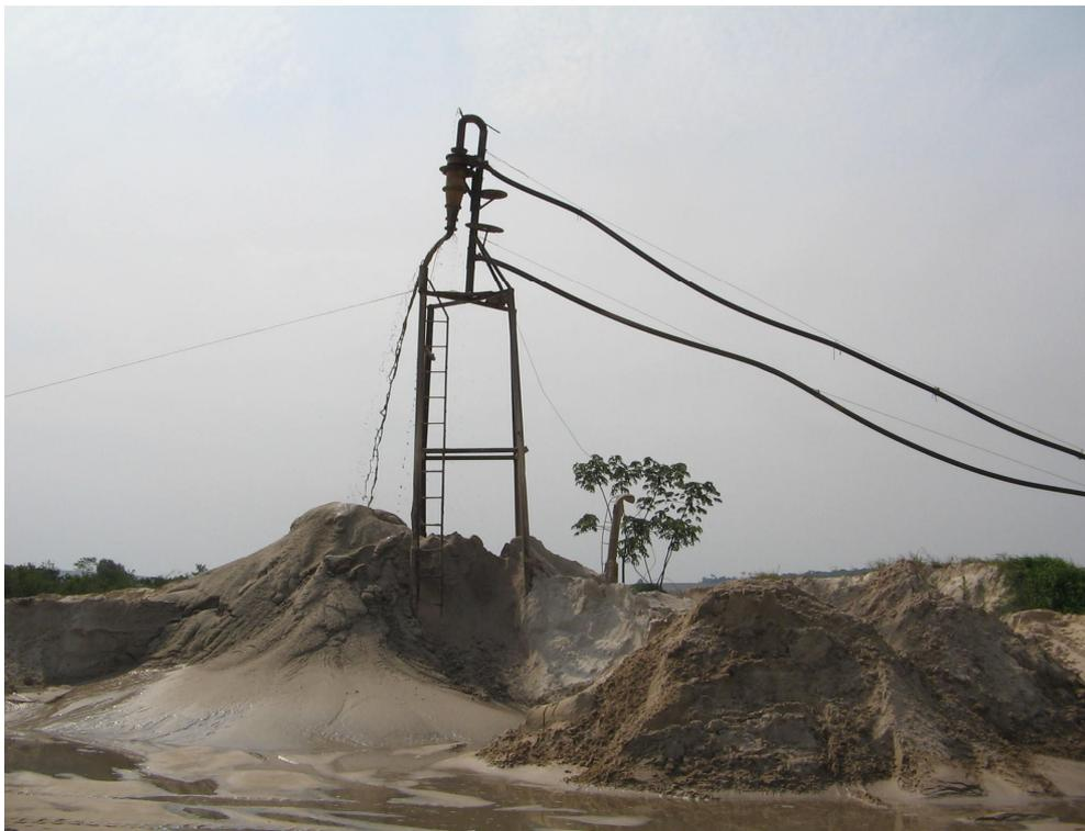
Figura 14 – Hidrociclone, equipamento utilizado para separação de água e areia fina.
