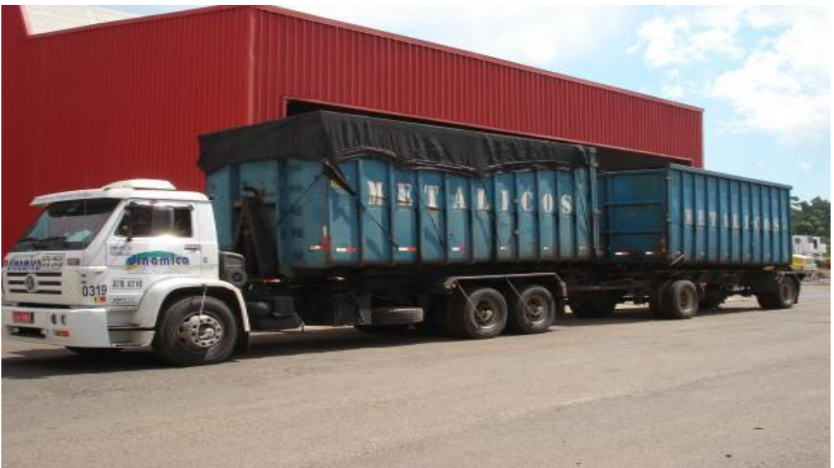
Figura 12 - Semi-reboques fechados para transporte de cavacos ou a granel.
