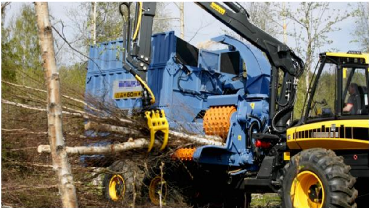
Figura 203 - Picador instalado sobre Forwarder
