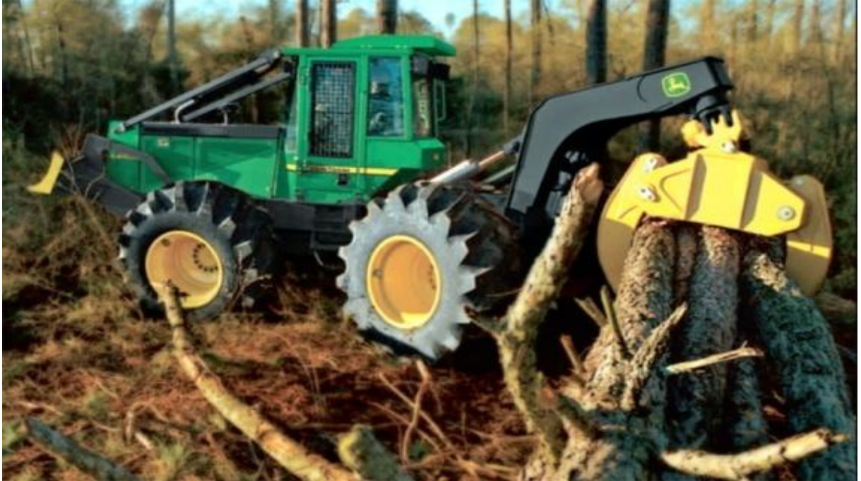
Figura 6 - Trator Skidder utilizado na operação de arraste.
