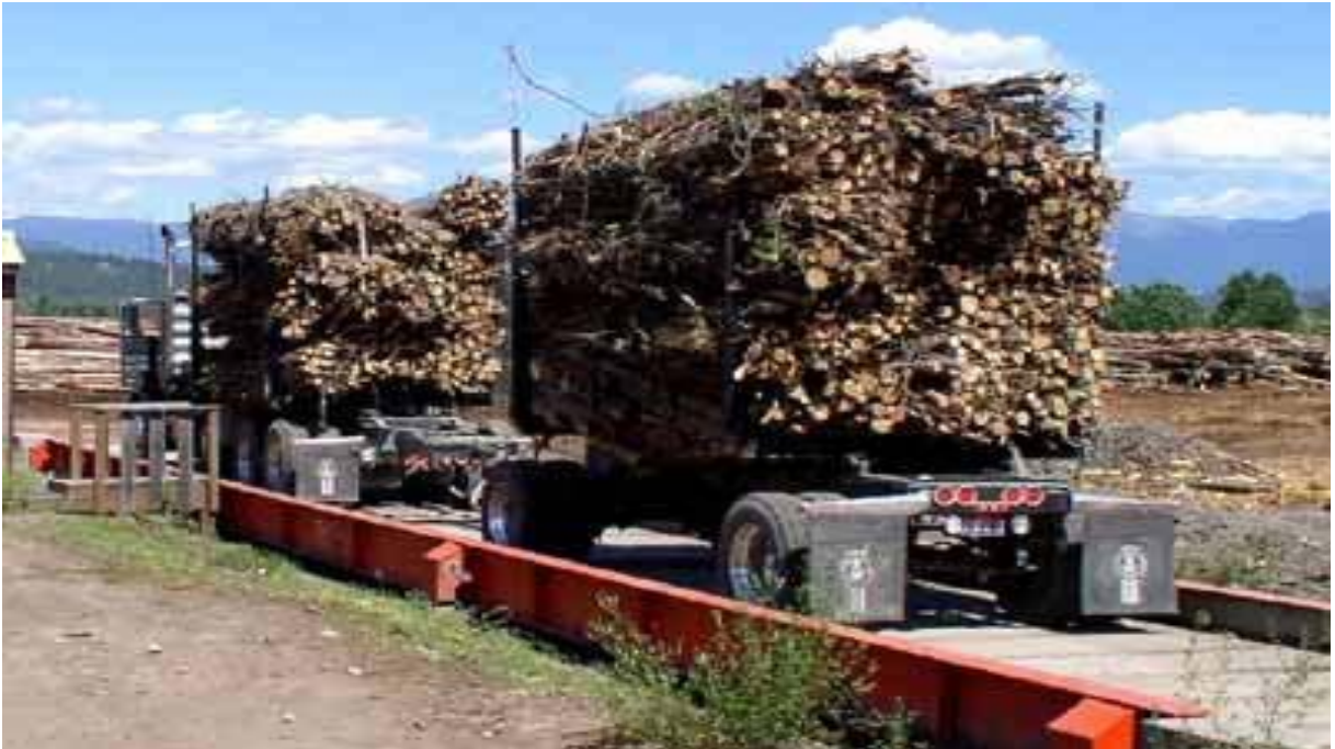
Figura 11 - Reboque para toras com 4 fueiros.
