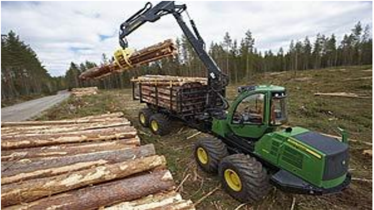
Figura 7 - Forwarder utilizado na operação de baldeio.
