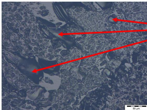
Fases vidradas e bolhas, característicos de materiais cerâmicos, como no caso a alumina (Al<sub>2</sub>O<sub>3</sub>) causou em várias partes das amostras.
