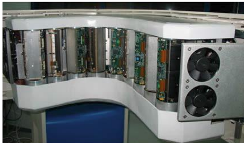
Figura 17- Conjunto detector CZT
