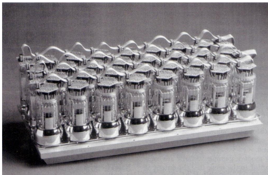
Figura 13- Conjunto de fotomultiplicadoras acopladas no cristal de NaI(Tl).
