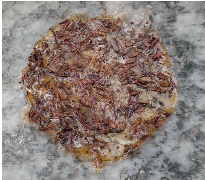
Figura 11 - Amostra nº 7 com fibra sem tratar e seca em estufa
