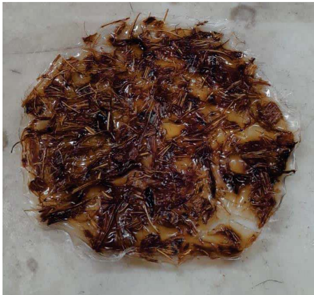
Figura 9 - Amostra nº 5 fibras tratadas e secas em temperatura ambiente
