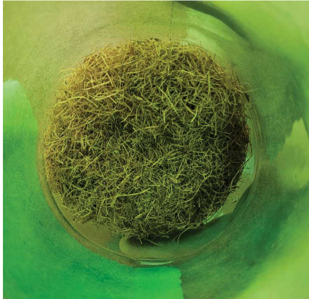
Figura 8 - Fibra 3 tratada e seca em temperatura ambiente
