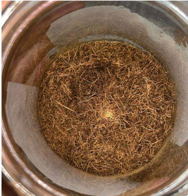
Figura 7 - Fibra 2 tratada e seca em estufa
