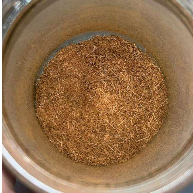
Figura 6 - Fibra 1 não tratada e seca em estufa
