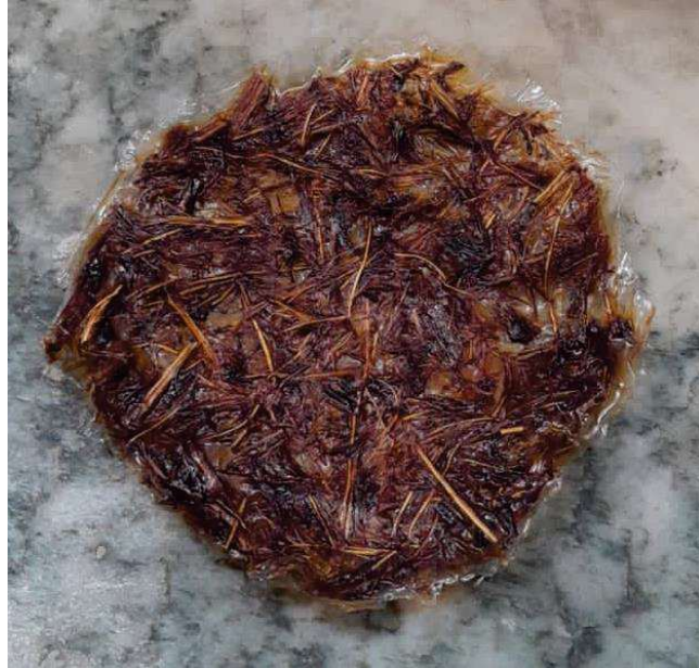
Figura 10 - Amostra nº 6 com fibra tratada e seca em estufa
