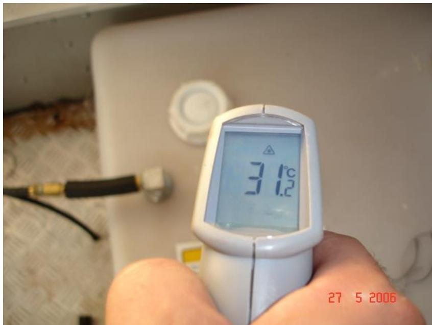
Figura 16: Temperatura do óleo vegetal no tanque.
