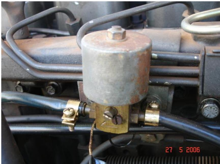
Figura 7 - Válvula elétrica para controle de retorno de Diesel para tanque
