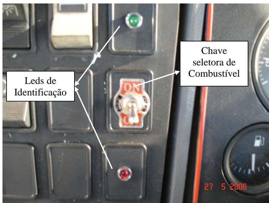
Figura 9 - Chave seletora de Combustível e Leds de identificação
