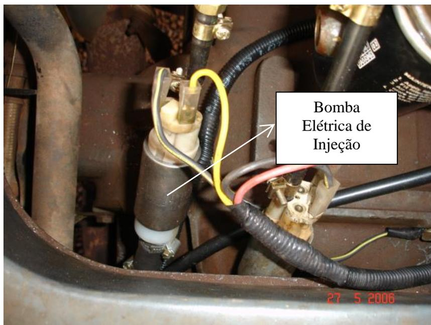
Figura 4 - Bomba Elétrica de Injeção
