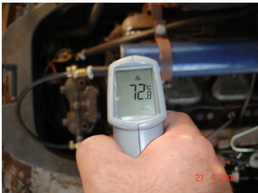
Figura 15: Temperatura do óleo vegetal na saída do filtro
