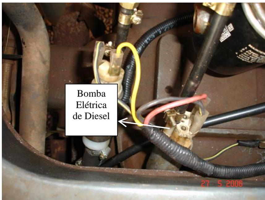
Figura 8 - Bomba Elétrica Adaptada para Diesel
