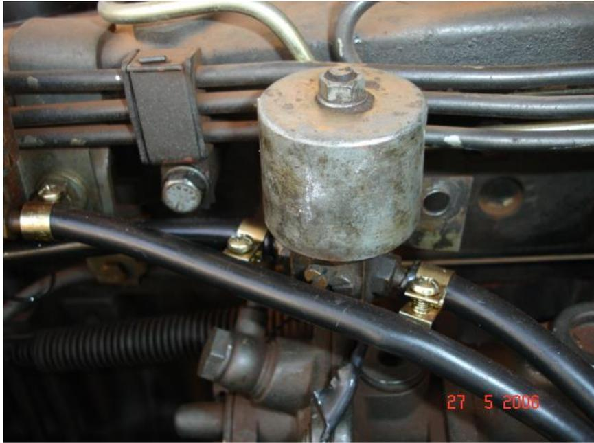
Figura 6 - Válvula elétrica para controle de retorno de Óleo Vegetal para tanque
