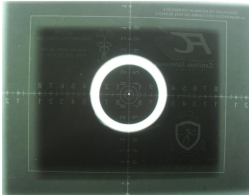
Figura 18: Teste de colimação e alinhamento do eixo central do feixe de raios-X
