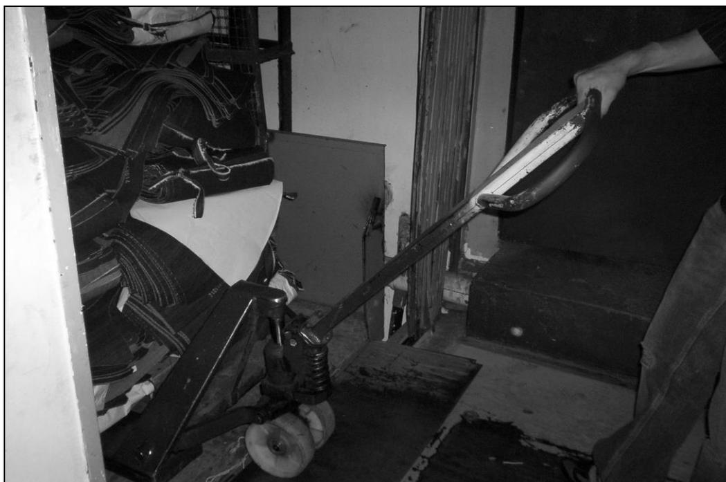
**Figura 3:** Paleteira hidráulica retirando palete do elevador de carga
