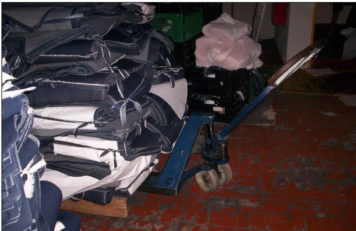
**Figura 4:** Paleteira hidráulica movimentando palete na área de armazenamento
