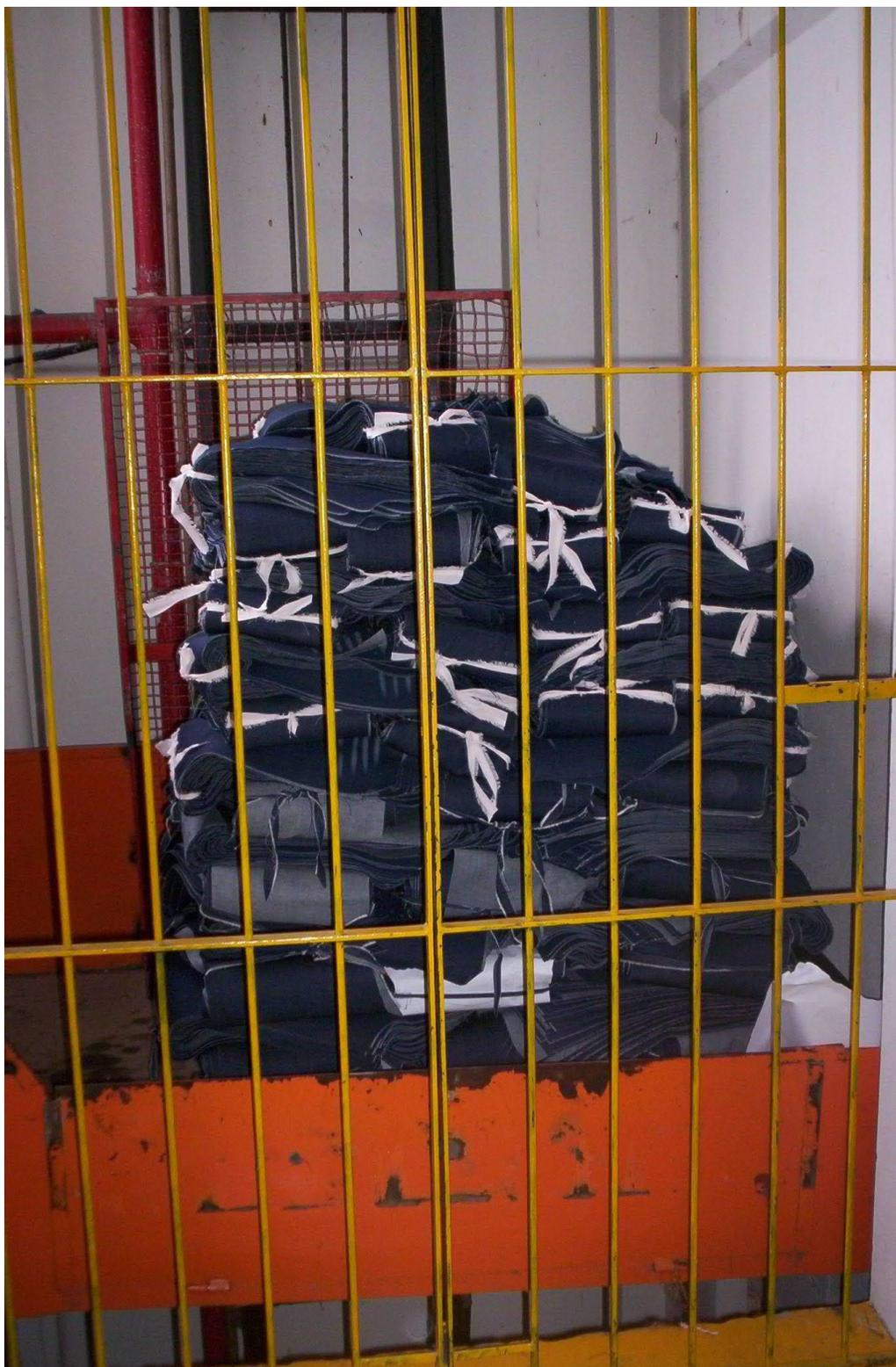
**Figura 11:** Elevador transportando as folhas de corte descarregadas até a área de armazenamento
