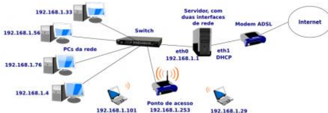
Figura 15 – Rede privada utilizando apenas um IP válido para roteamento dos dados na internet.
