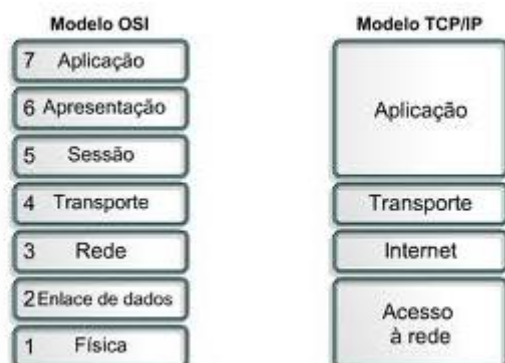
Figura 8 – comparação dos modelos de camadas ISO e TCP/IP
