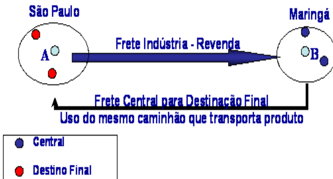
Figura 7: Para gerir o processo logístico, o inpEV utiliza o conceito de logística reversa, que consiste em disponibilizar o caminhão que leva os agrotóxicos (embalagens cheias) para os distribuidores e cooperativas do setor e que voltariam vazio, para trazer as embalagens vazias (a granel ou compactadas) armazenadas nas unidades de recebimento. Fonte: inpEV
