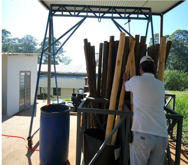
Figura 7- Colocação dos mourões verticalmente nos tambores
