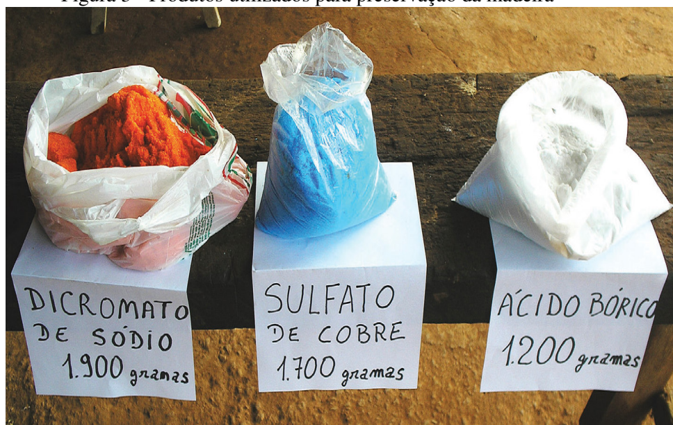
Figura 3 - Produtos utilizados para preservação da madeira
