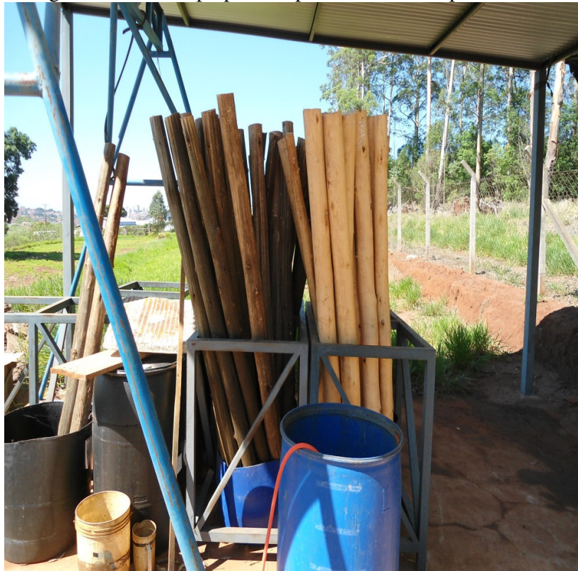
Figura 8- Mourões preparados para o tratamento preservativo
