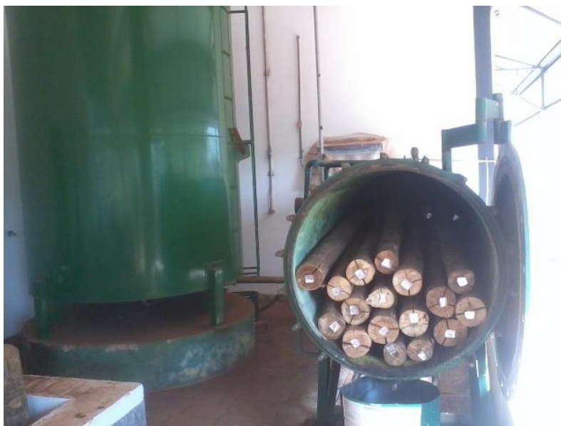
Figura 2 - Início do processo de conservação dos mourões
