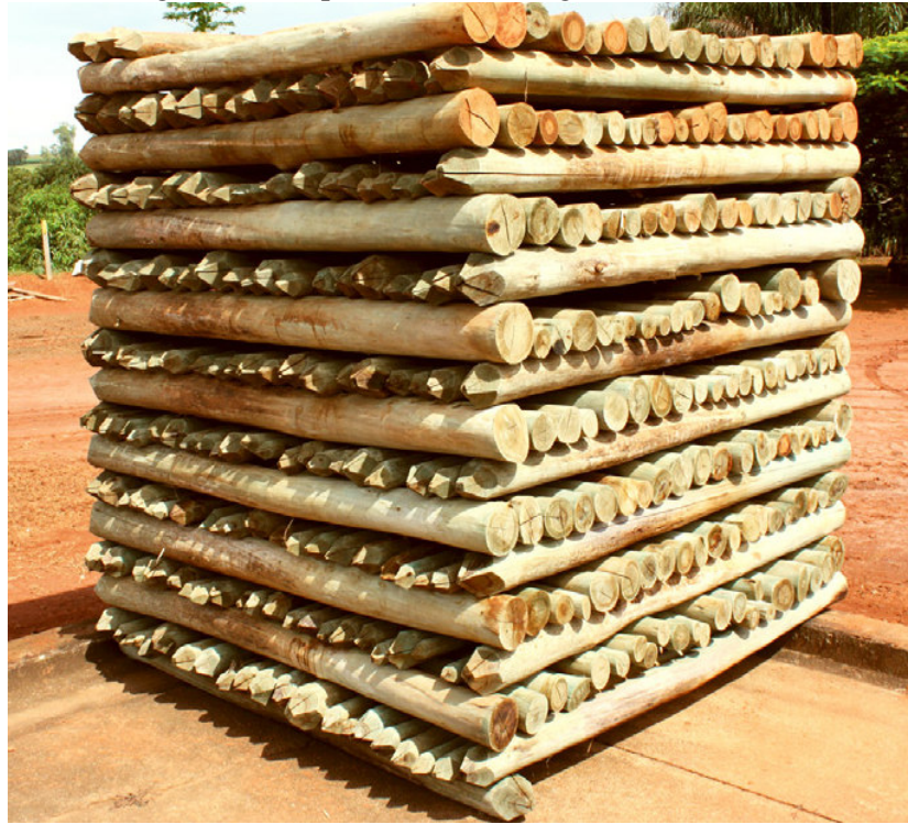
Figura 12- Empilhamento e secagem dos mourões
