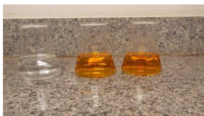
Figura 03. Titulação do ozônio com tiosulfato de sódio.
