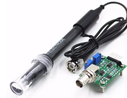
Figura 2 - pH eletrodo sonda BNC Arduíno + módulo sensor
