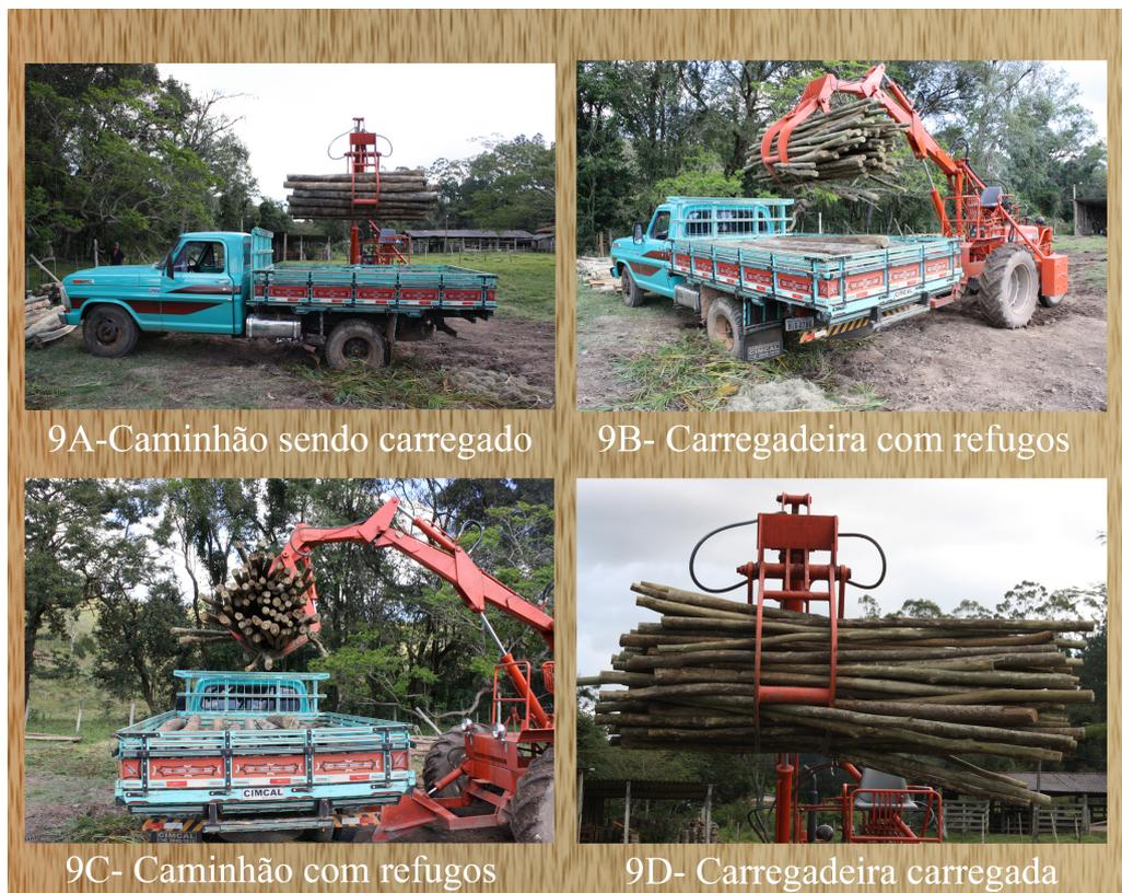
Figura 9A, 9B, 9C, 9D – Caminhão sendo carregado pela carregadeira
