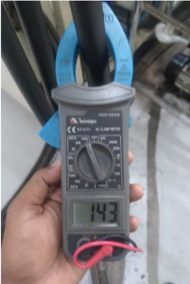
Imagem 3 – Medição de corrente com Alicate amperímetro do forno de sinterização
