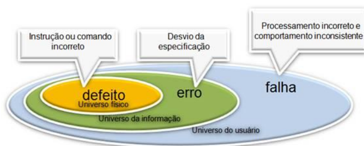
Figura 1 - Erro, defeito e falha. Fonte: Arilo Neto, 2007 p. 55
