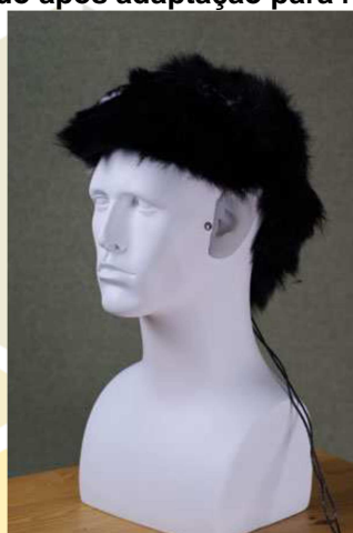
Figura 13: Manequim finalizado após adaptação para realizar gravações de áudio 3D
