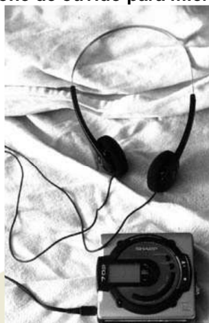
Figura 9: Adaptação de um fone de ouvido para microfone para gravação binaural
