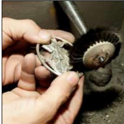
Figura 22: Acabamento em joias
