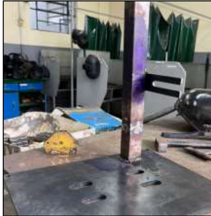
Figura 34: Metalon soldado na base
