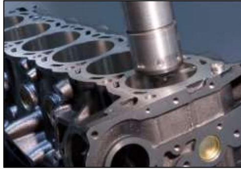
Figura 16: Processo de Brunimento
