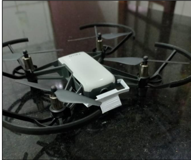
Figura 3.2 - Drone com o suporte para o espelho.
