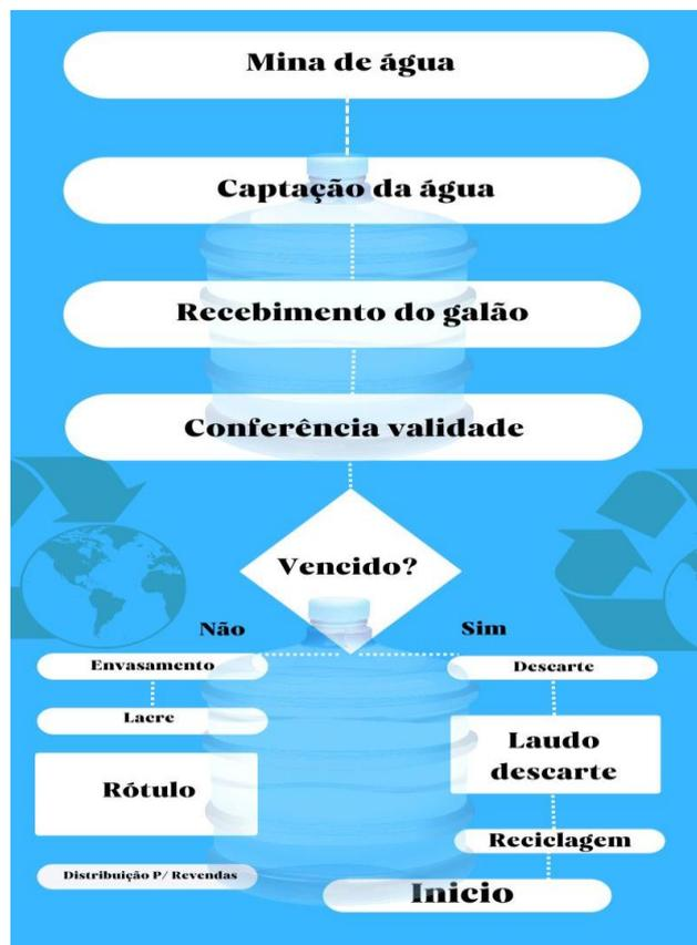
Figura 3: Diagrama do processo de envase.
