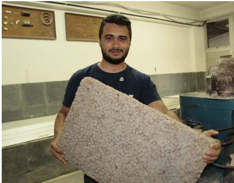
Figura 14 - Utilização do caroço de açaí na construção civil – Chapa de concreto
