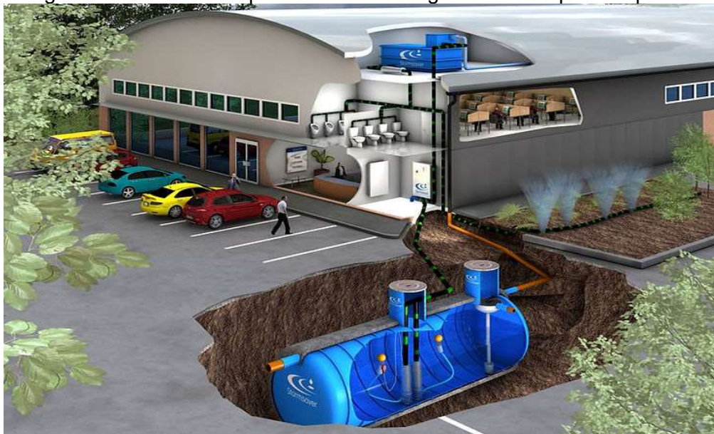
Figura 1 – Sistema de aproveitamento de água da chuva para empresas
