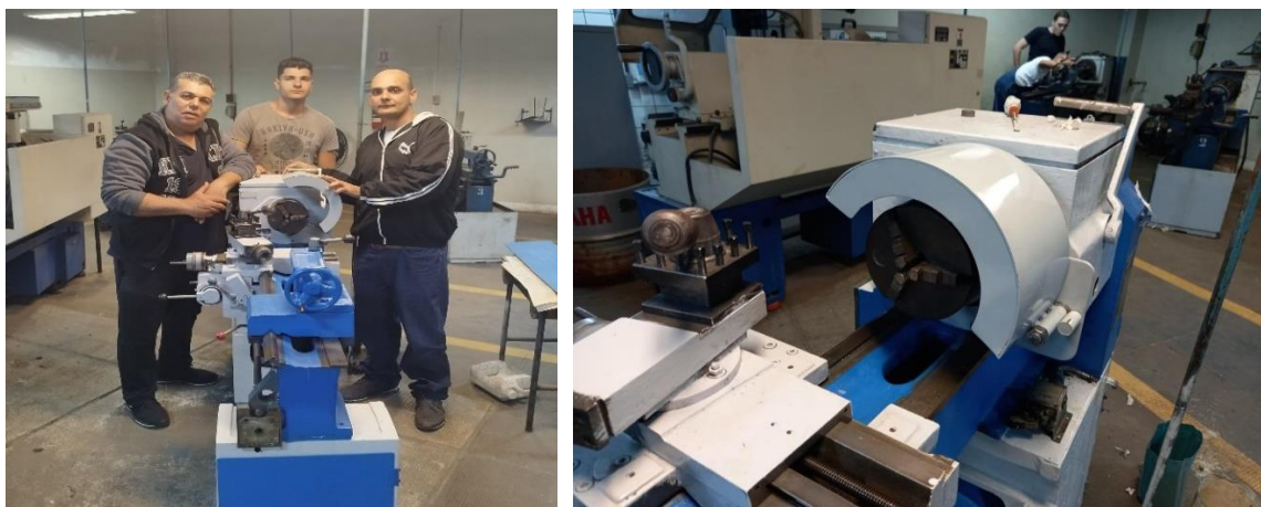
Figura 17 – Depois da adaptação da proteção Fonte: Autores, (2023).
