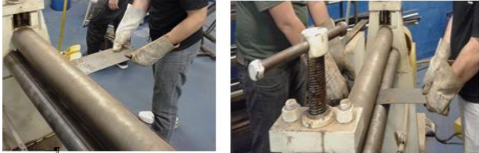
Figura 9 – Conformação das chapas na calandra Fonte: Autores, (2023).
