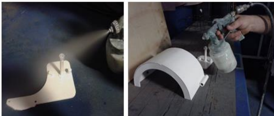
Figura 14– Pintura das peças da proteção da placa Fonte: Autores, (2023).
