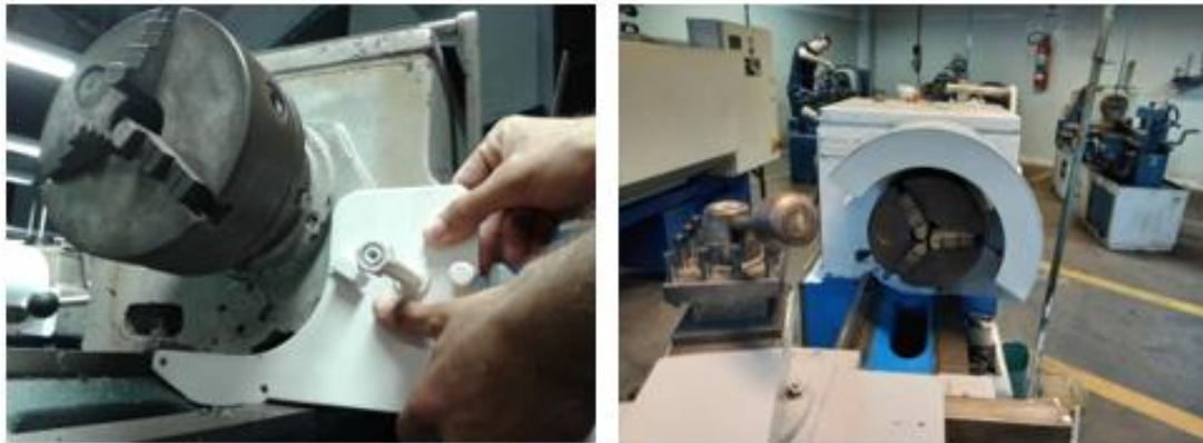
Figura 15 – Instalação do conjunto montado no torno Fonte: Autores, (2023).
