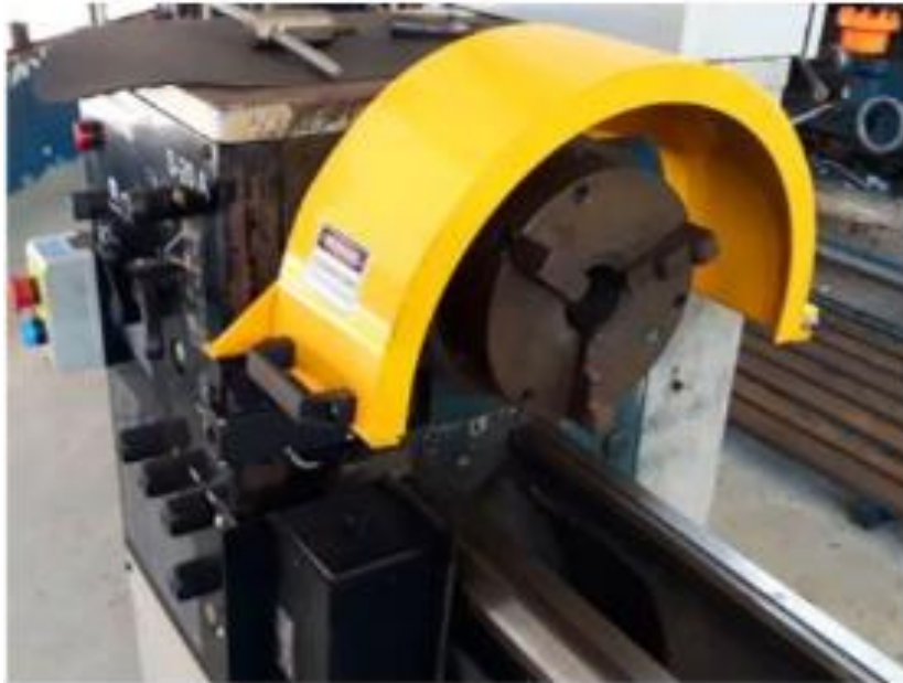
Figura 6 – Proteção móvel da placa do torno NR12 Fonte:
