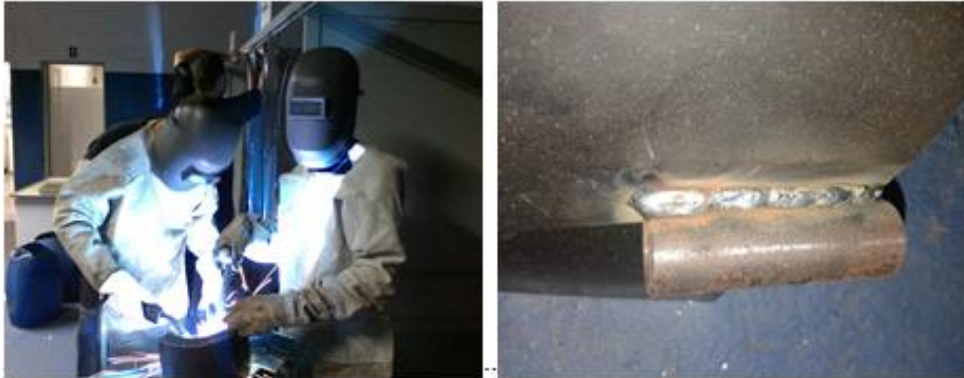
Figura 12 – Processo de soldagem MIG Fonte: Autores, (2023).
