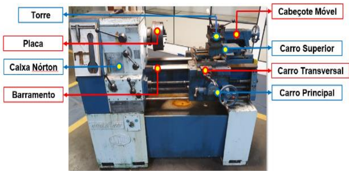
Figura 8 - Partes do torno mecânico universal Fonte: Autores, (2023).
