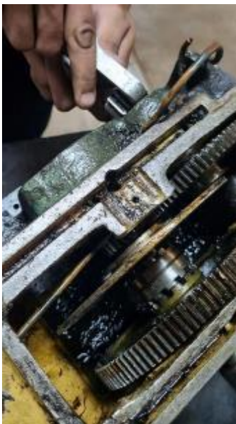
Figura 34 - Caixa de engrenagem, Carro Principal Fonte: Autores, (2022).
