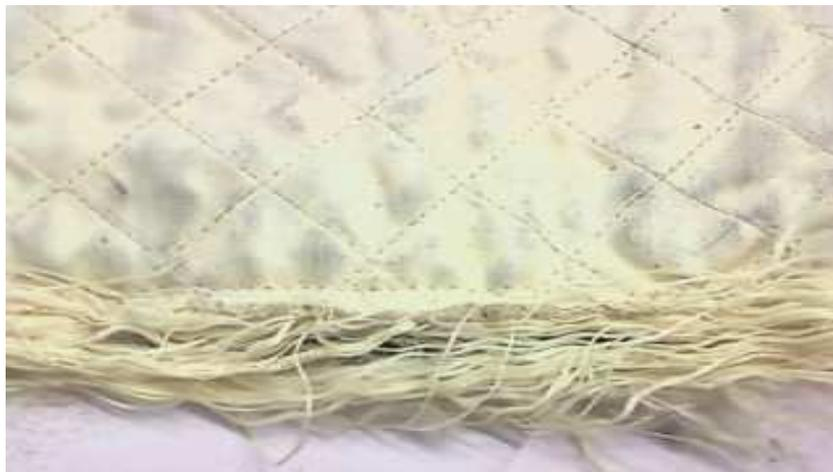
Figura 08 Observe que dentro das costuras existem bolhas de ar e o acabamento da placa todo degradado, do autor, Brasil 2012.
