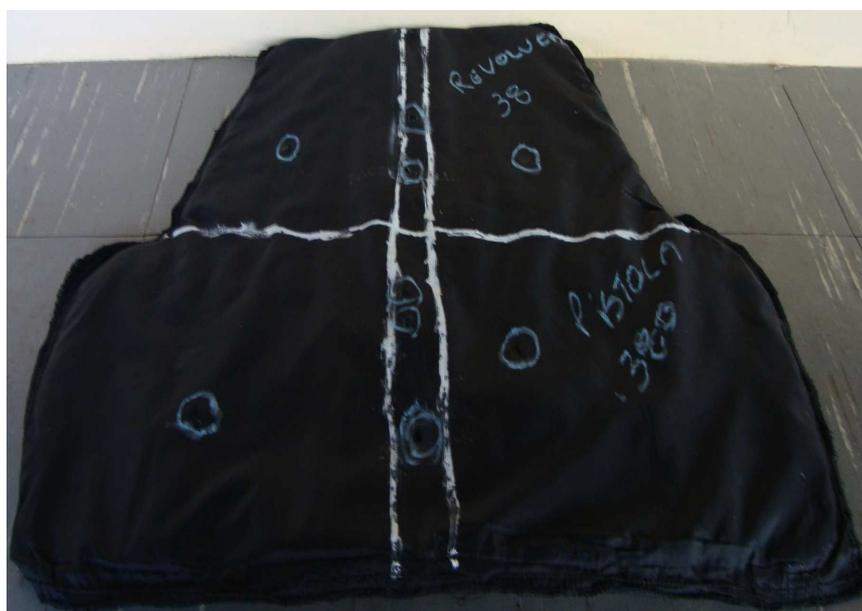
Figura 20 Duas listras na vertical marca a dobra e uma listra na horizontal marca a parte superior e inferior do colete, do autor, Brasil 2012.
