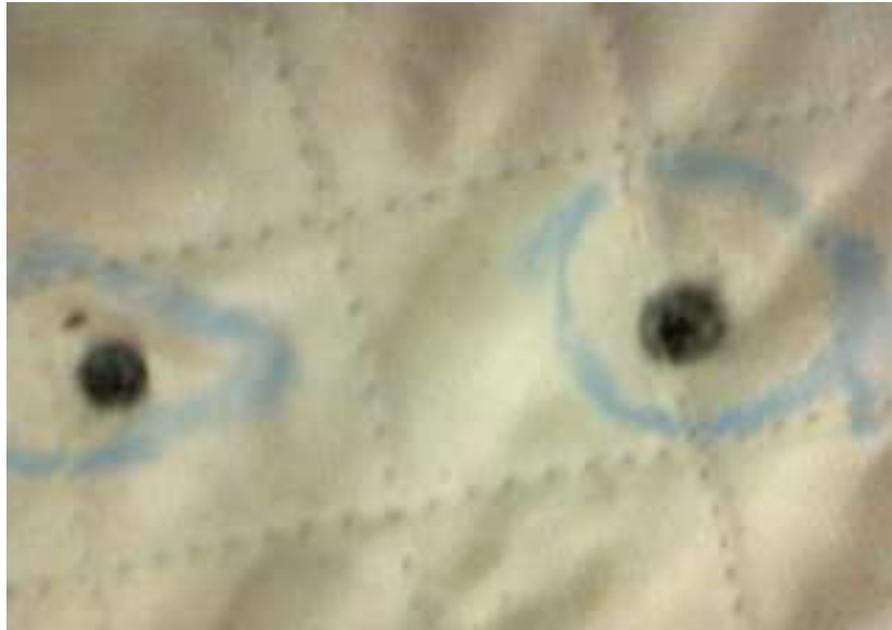
Figura 27 O ponto de impacto deixado pelos disparos a queima roupa, a esquerda munição +P+ e a direita ogival.
