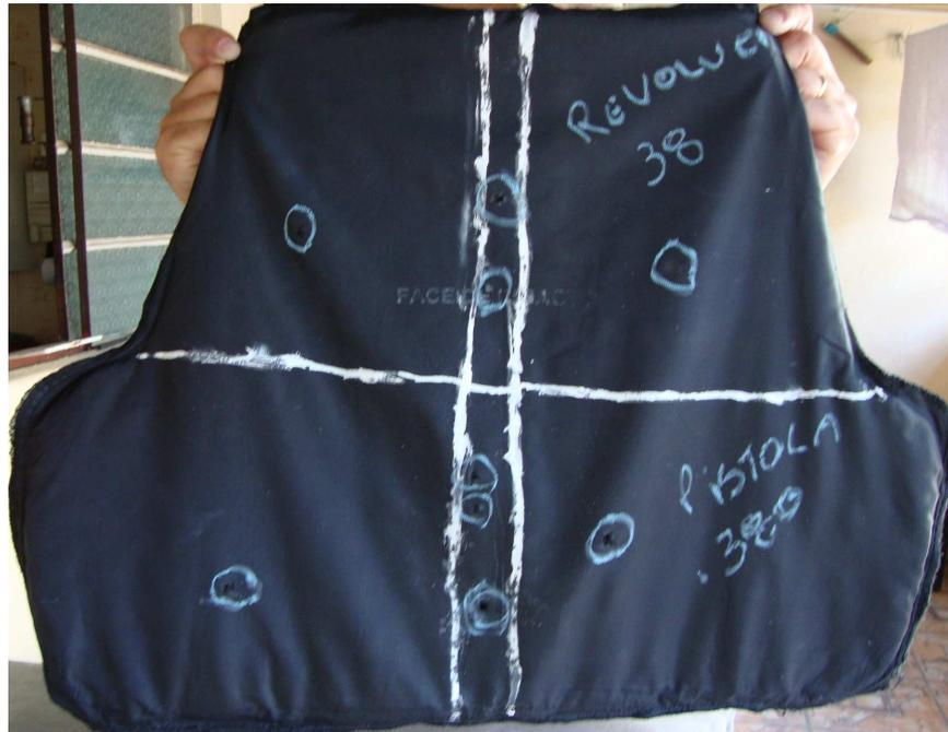
Figura 21 Pontos de impactos marcados de cor azul, parte superior revolver e inferior pistola, do autor, Brasil 2012.
