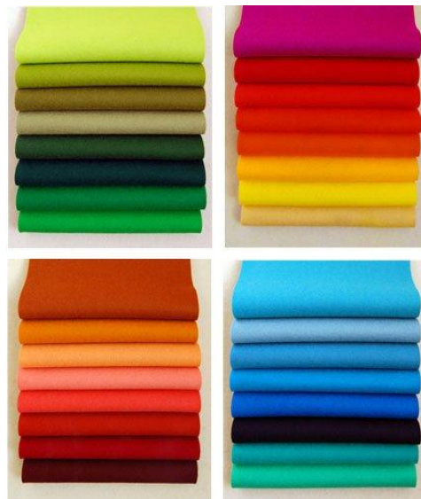
Ilustração 3: Nãotecido Agulhado, comercialmente chamado de feltro sintético Fonte: portuguese.alibaba.com - acesso em: 27/05/2012
