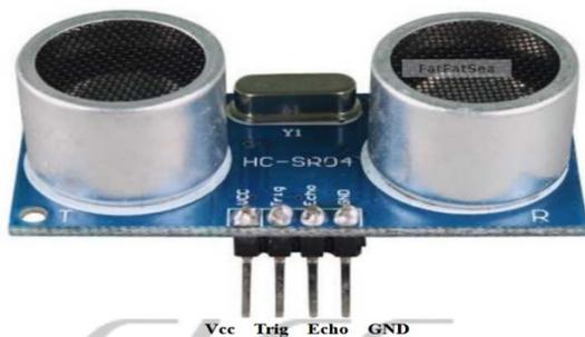
Fonte: Datasheet Ultrasonic ranging module HC SR04
