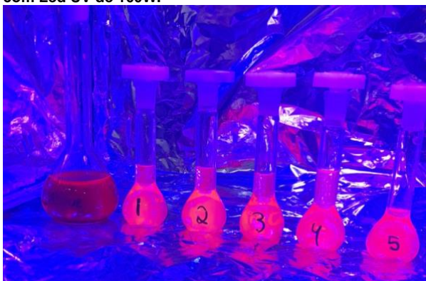
Figura 9: Soluções de Rodamina B em estado de excitação com Led UV de 100W.
