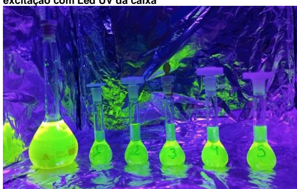
Figura 14: Soluções de Fluoresceína em estado de excitação com Led UV da caixa
