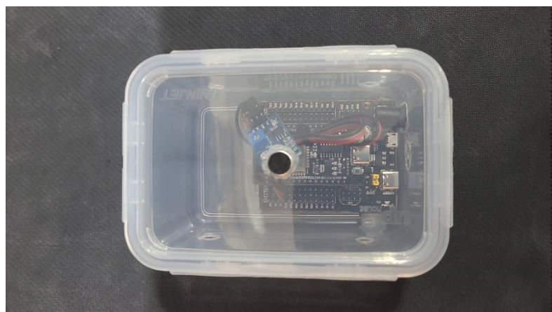
Figura 5. Recipiente de plástico para armazenar o ESP32 com o módulo de som
