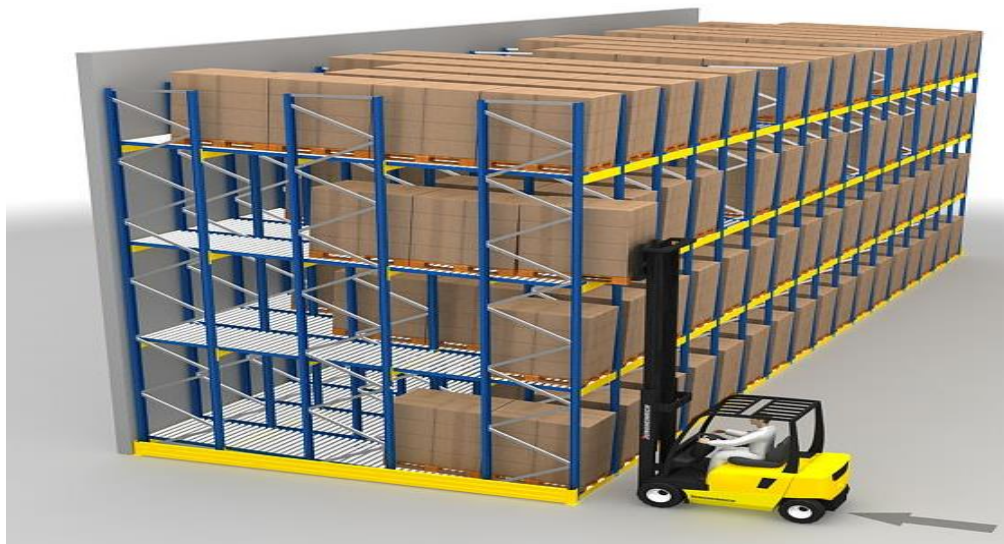
Figura 3- Porta Paletes dinâmico ou “Rollin”-
