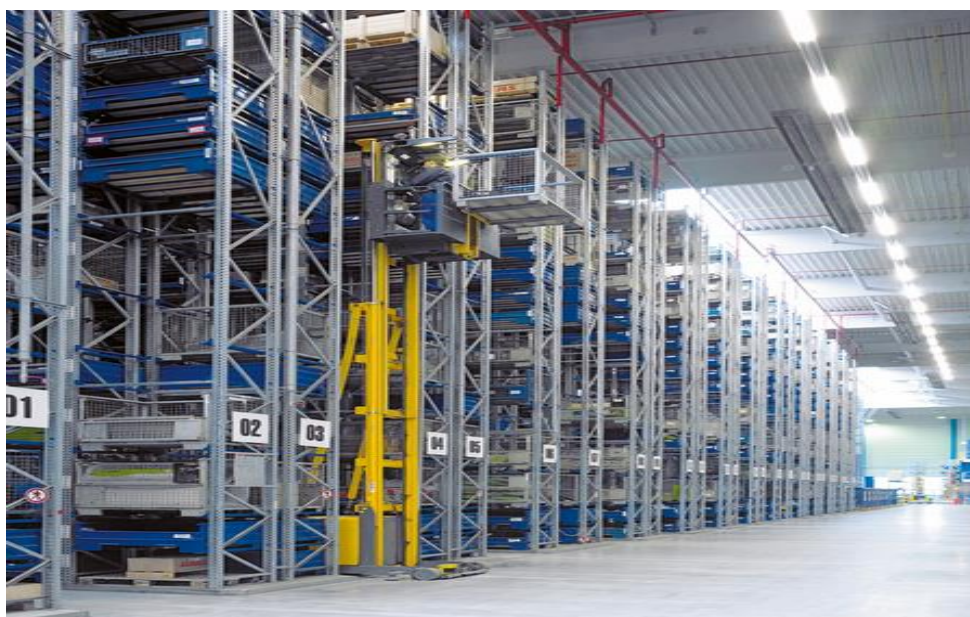
Figura 6- Estrutura Porta Paletes Alto Verticalizadas
