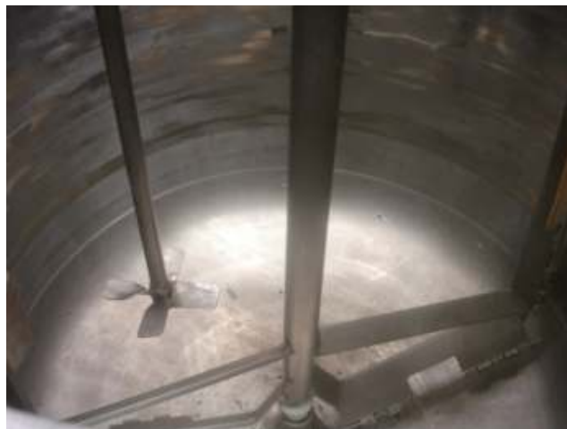
Figura 9: Agitador estilo âncora
