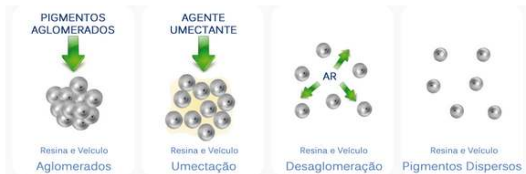
Figura 11: Esquema da distribuição das partículas no veículo
