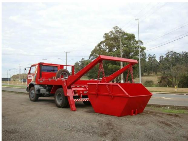
Figura 1: Caminhão para transporte de caçambas do tipo *Brook*.
