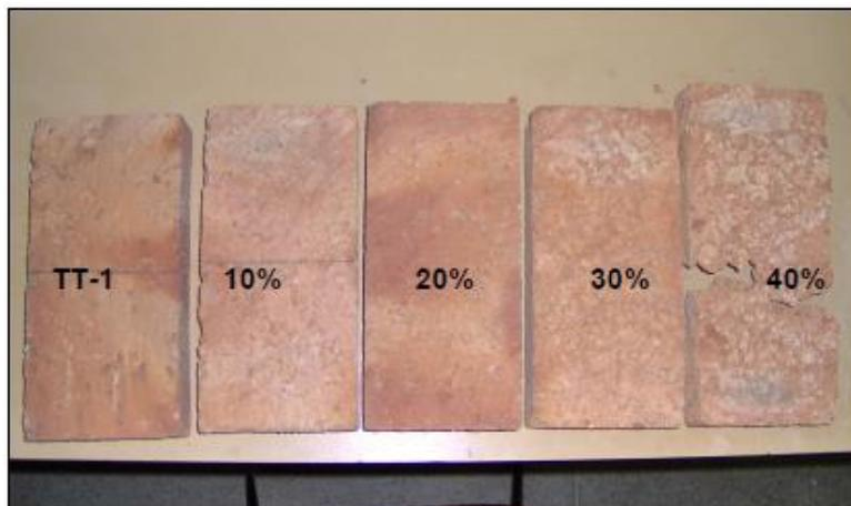
Figura 10: Tijolos fabricados com adição de lodo (1ª etapa de fabricação).
