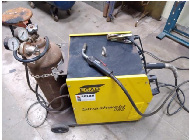
Figura 18. Máquina de solda MIG, utilizada na soldagem.
