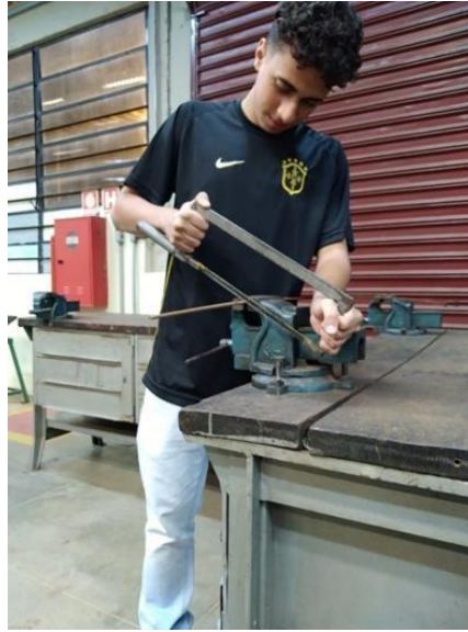
Figura 15. Gabriel serrando ferro liso para dobra de novos ganchos.
