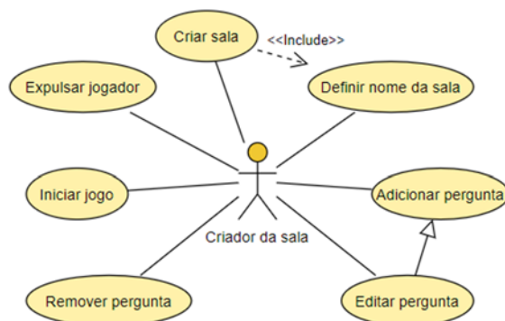
Figura 11 – Diagrama de casos de uso sobre a tela de gerenciamento de salas de jogo
