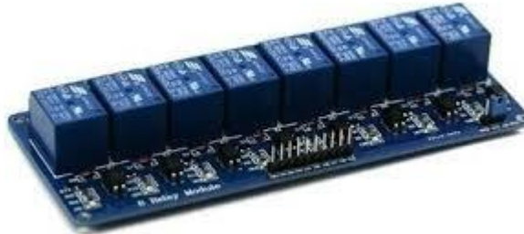
Foto 02 - Modulo Relé 5V com 8 canais
