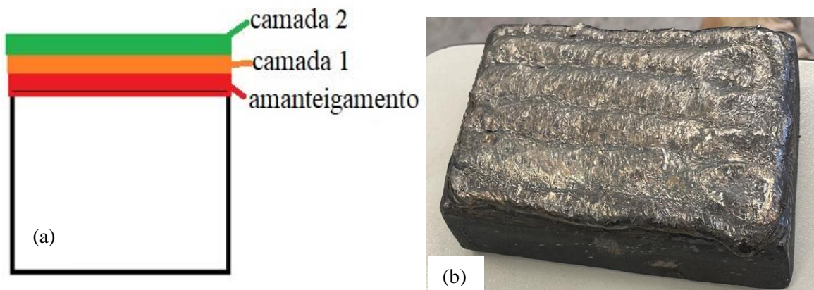
Figura 3 – Soldagem de enchimento do corpo de prova. (a) esquema representativo das camadas soldadas. (b) superfície do corpo de prova após soldagem.
